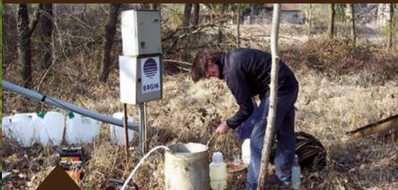
Prélèvement et mesure du niveau d'eau souterraine dans un forage
