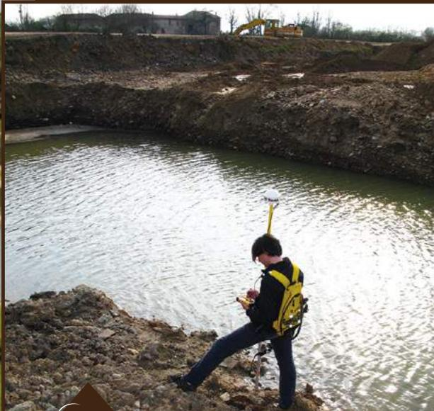
Nivellement au gps du niveau d'eau dans une gravière en exploitation
