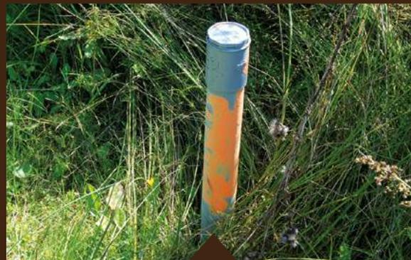
Piezomètre mesurant les niveaux d'eau avant et après travaux
