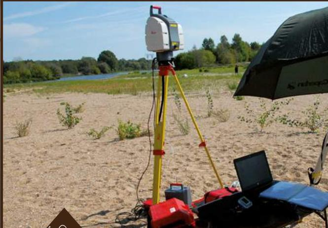
*Mesure topographique de la barre sédimentaire par balayage laser*
